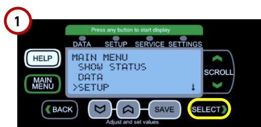
Appuyer sur MAIN MENU, aller à SETUP, appuyer sur SELECT.
