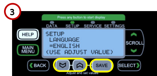
Sélectionner le langage approprié, appuyer sur SAVE.
